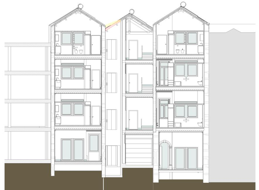
Corte A.2 - demolição / construção
